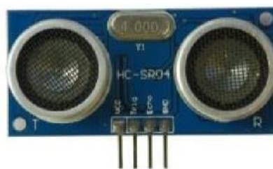
Gambar 2.12 Konfigurasi pin dan tampilan sensor ultrasonik
