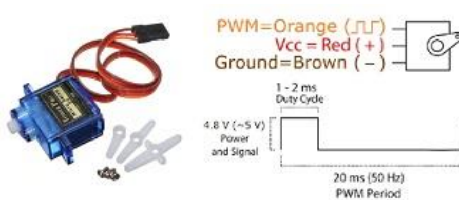
Gambar 2.4. Pinout Servo dan bentuk fisik
