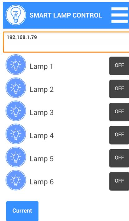
6. Setelah tersambung lalu lakukan pengontolan, maka lampu akan berubah menjadi ON/warna berubah menjadi merah
